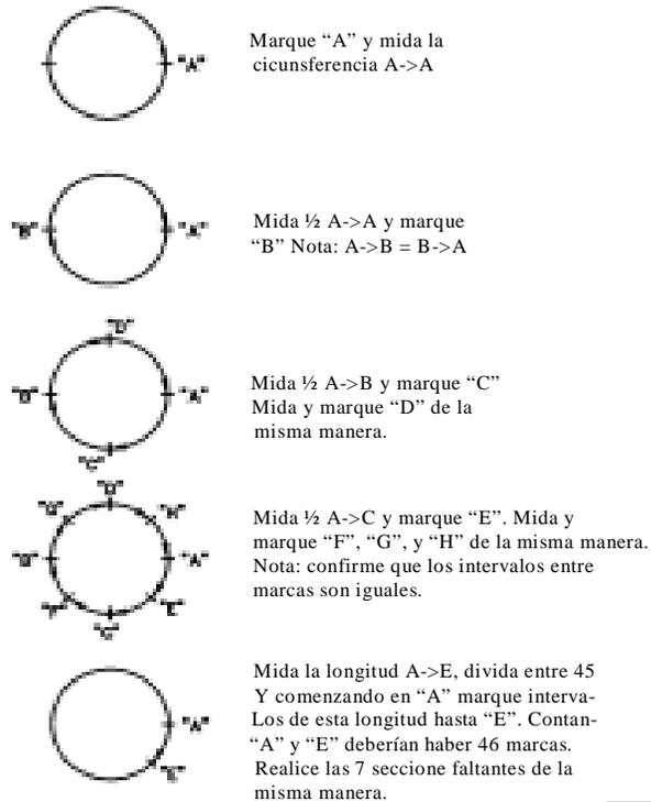
PROCEDIMIENTO PARA PERFORAR 360 AGUJEROS EN EL VOLANTE DEL MOTOR
